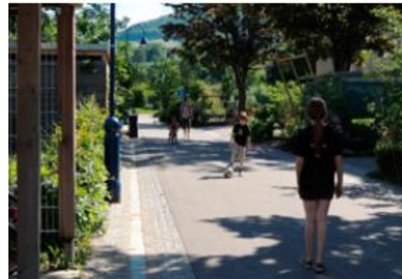
Exemple de voie partagée en milieu plus urbain, absence de trottoirs et de stationnement pour les véhicules, le caniveau forme la frontière entre l'espace public et l'espace privé, les espaces privatifs sont paysagers.
